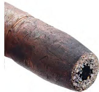
Boquilla totalmente obstruida (que no utiliza E-WELD Nozzle)
