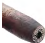
Buse complètement bouchée (sans E-WELD Nozzle)
