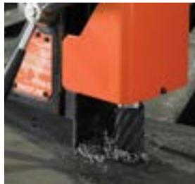
Pour un plus grand trou, 1/2" et plus, utilisez la base magnétique avec une tige Weldon standard.
