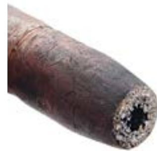
Buse complètement bouchée (sans E-WELD Nozzle)
