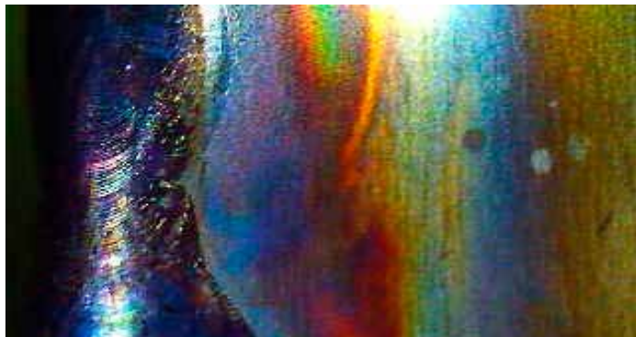
Zone affectées thermiquement lors de la soudure.
